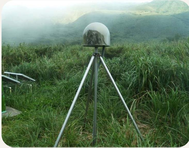
GNSS衛星導航系統天線
