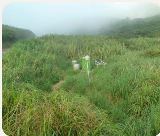
GNSS衛星導航系統天線及接收器(陽明山小油坑)
