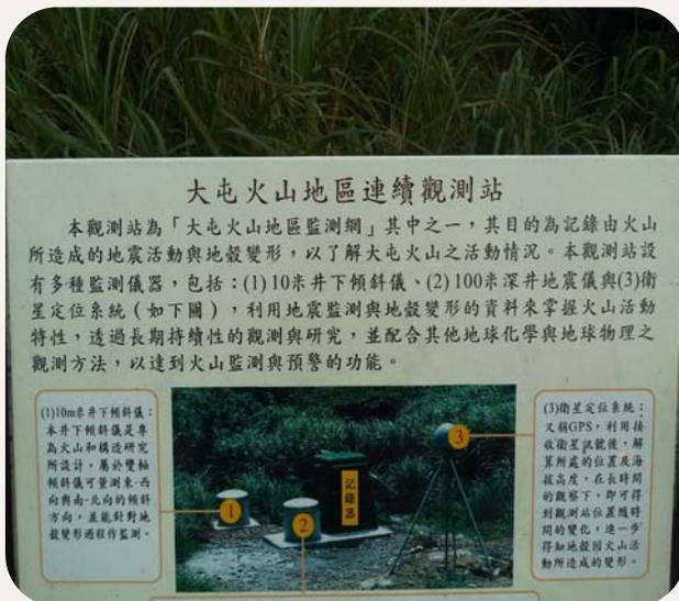
GNSS衛星導航系統(GPS)說明
