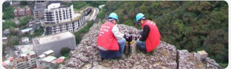
圖6 傾度盤觀測儀器
