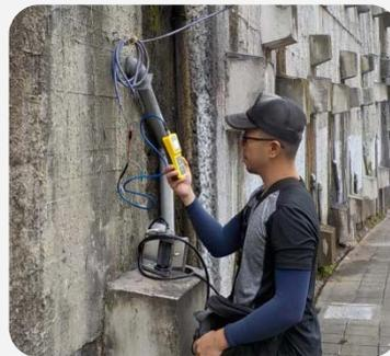
圖7 地錨荷重計觀測儀器
