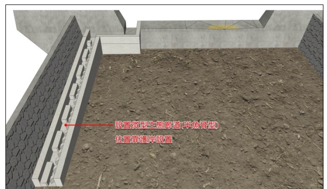
圖二(f)設置微型生態廊道，位置靠護岸設置
