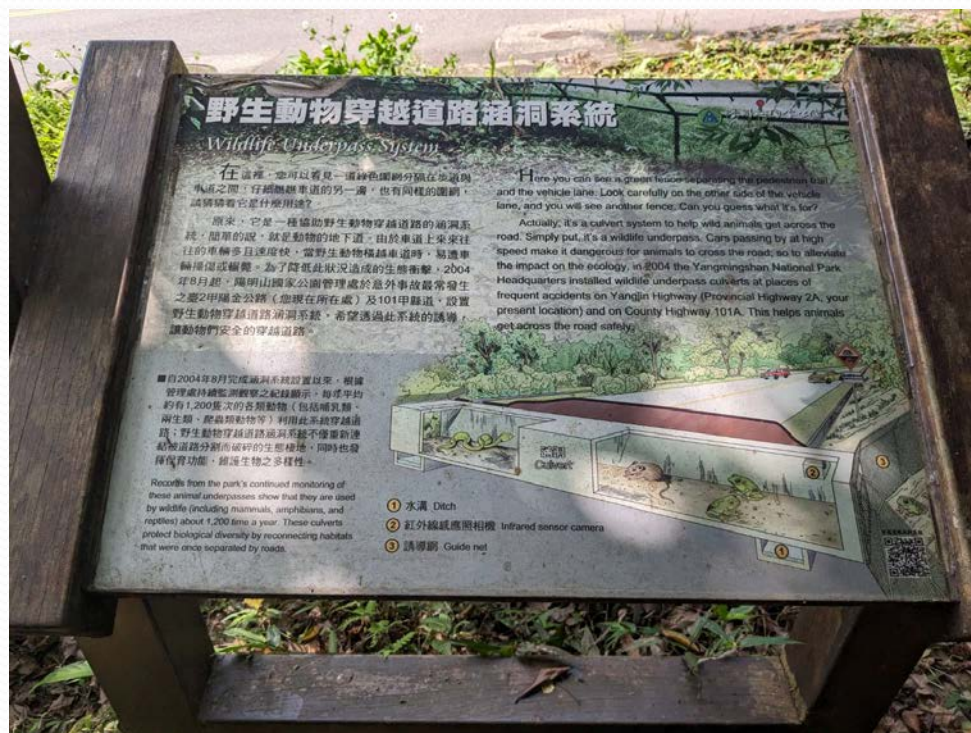
▲野生動物穿越道路涵洞系統說明牌(臺2甲陽金公路)
