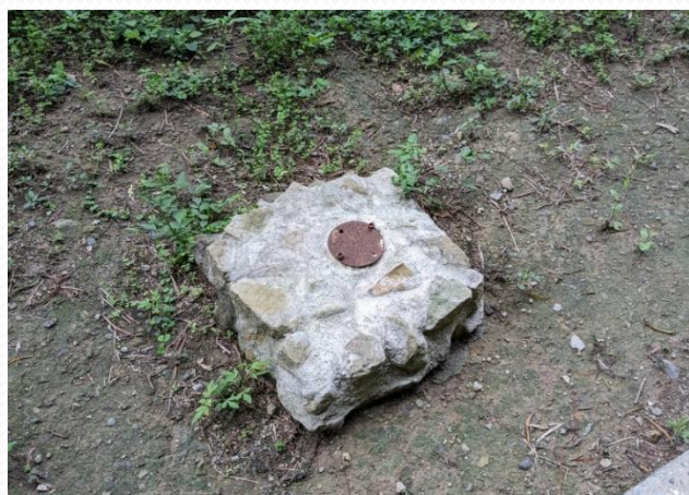
▲國五人工地層位移監測
