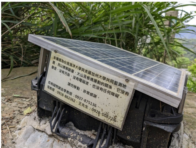
▲魚路古道沿途的科研儀器(為台灣海洋大學與美國加州大學共同監測地震,用以瞭解斷層、火山及板塊運動的關係。)
