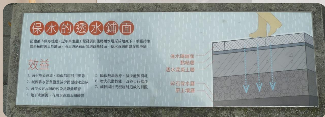
人行道透水鋪面設計，調節氣溫、涵養地下水源，也有助於減少積水面積
