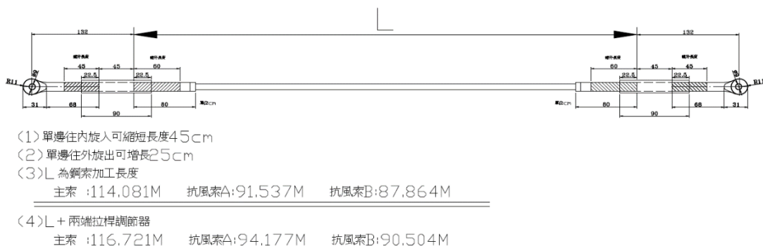
圖3-1 吊橋鋼索詳細組合長度示意圖
