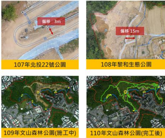
圖 8 空拍影像套疊水土保持圖說檢查成果
