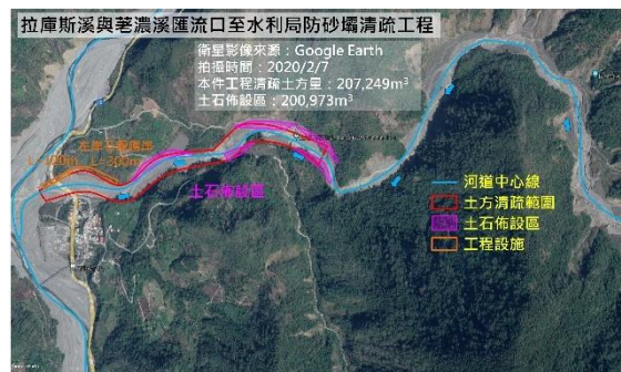
圖17 拉庫斯溪水利局第三座防砂壩上下游清疏工程示意圖
