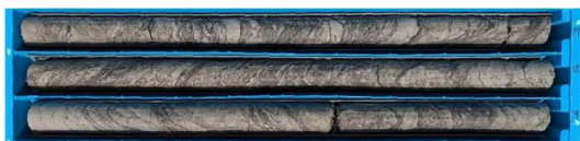
圖八、具絲狀及網絡狀斷層剪切帶
