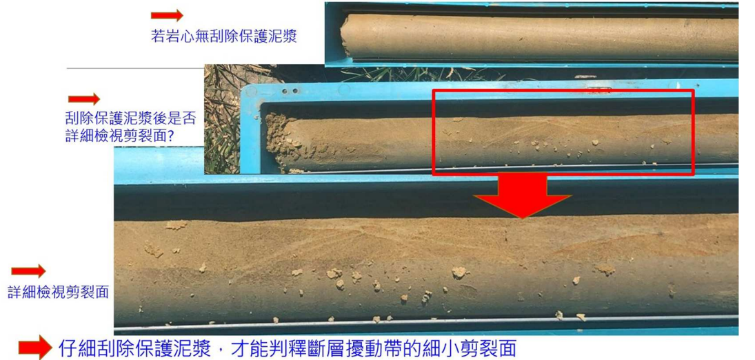
圖 4 岩芯判釋需仔細刮除保護泥漿，才能判釋斷層擾動帶的細小剪裂面
